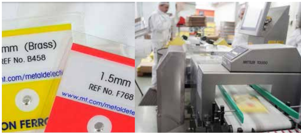
在每个 8 小时生产班次中对金属检测机测试五次。
