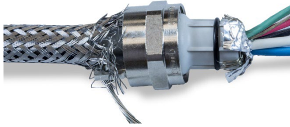
图 A-56：将内部编织屏蔽线和箔修剪到一定长度，然后向后折叠到索环上方
