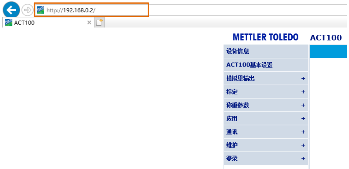
图 4-6: 使用浏览器连接至变送器
