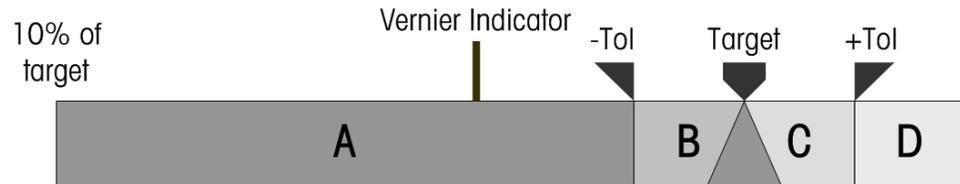
**Figura 4-19: Elementos del gráfico SmartTrac**
