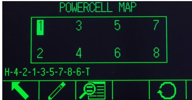
**Figura 3-35: Mapa de celdas de carga POWERCELL completado**
