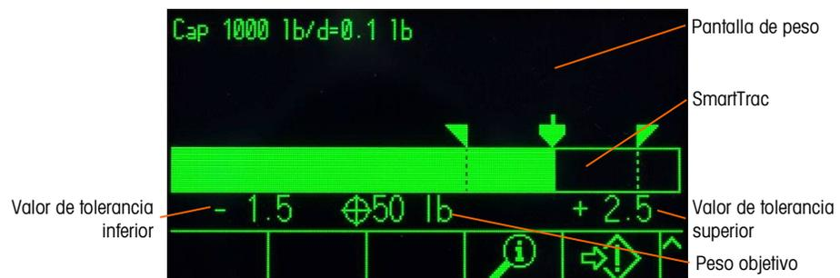
Figura 2-24: SmartTrac de transferencia de material, grande
