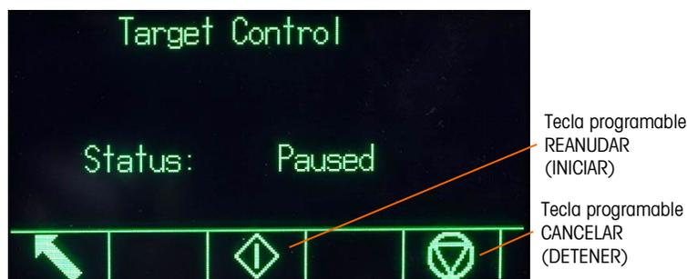
Figura 2-21: Ejemplo de condición pausada en el control de objetivo
