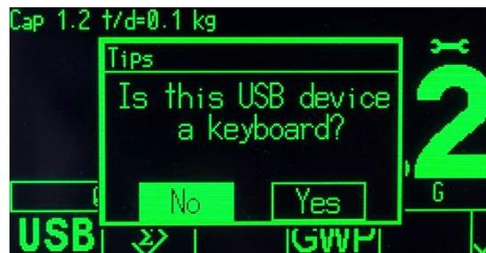
Figura 2-33: Indicación de identificación de dispositivo USB
