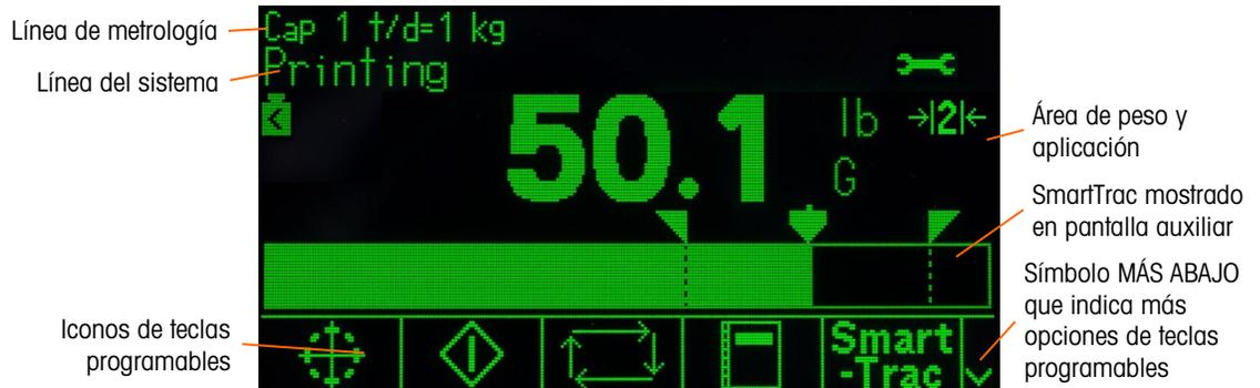
**Figura 2-14: Pantalla de inicio predeterminada, línea del sistema con mensaje de impresión mostrado**
