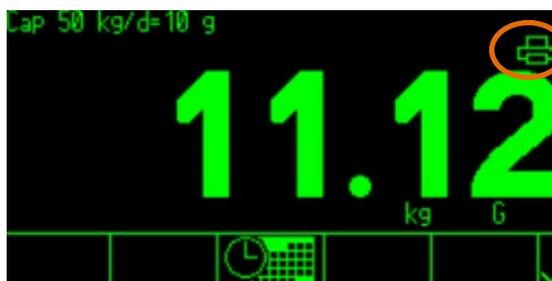
Figura C-5: Estado de la conexión de la impresora en la línea del sistema
