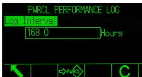
**Figura B-10: Pantalla de configuración del registro de desempeño PWRCL**
