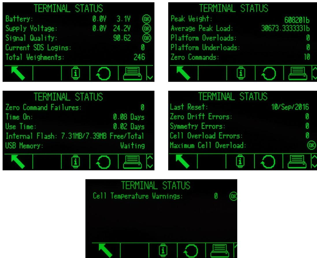
**Figura 4-14: Relatório de Status do Terminal (POWERCELL), Atualizado Observaciones del usuario**
