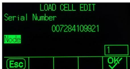
**Figura 3-12: Pantalla Editar celdas de carga de dirección manual**
