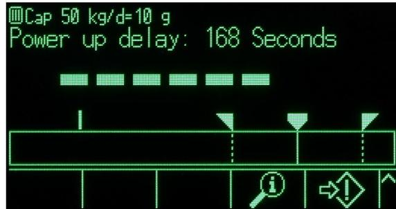
**Figura 3-6: Retraso de encendido mostrado en la línea del sistema**
