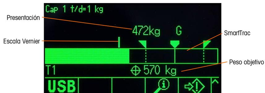
Figura 2-23: SmartTrac de transferencia de material, mediana
