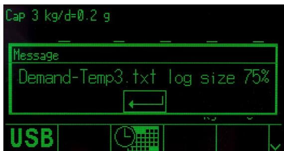
**Figura 4-3: Mensaje de advertencia de capacidad del USB**
