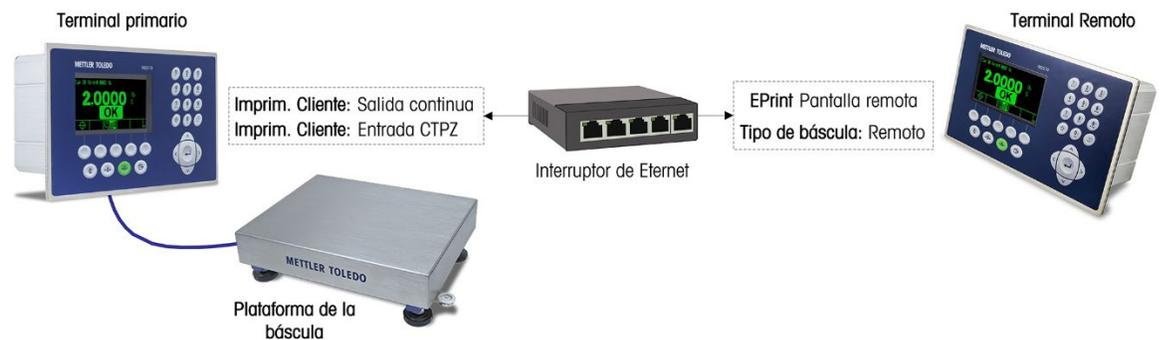
**Figura 4-16: Ejemplo de configuración de terminal para función de pantalla remota vía Ethernet**
