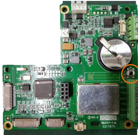
Figura 3-2: Ubicación del interruptor de configuración en la tarjeta principal del terminal
