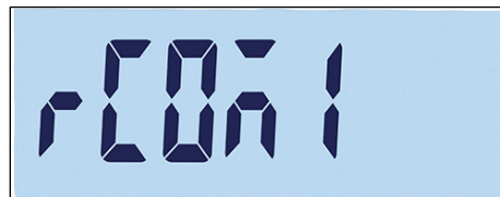
Figura 2-8: Configuración de tipo de báscula para operación remota
