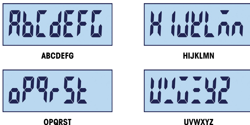
Figura 2-2: Pantalla LCD segmentada de caracteres alfabéticos
