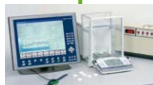
Module de poste de test avec station de pesage, contrôleur de comprimés et mesure de volume
