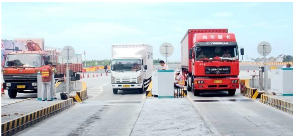
图2 专用检衡车进行动态检定
