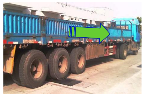
步骤3. 车辆后轴上秤前紧急刹车
