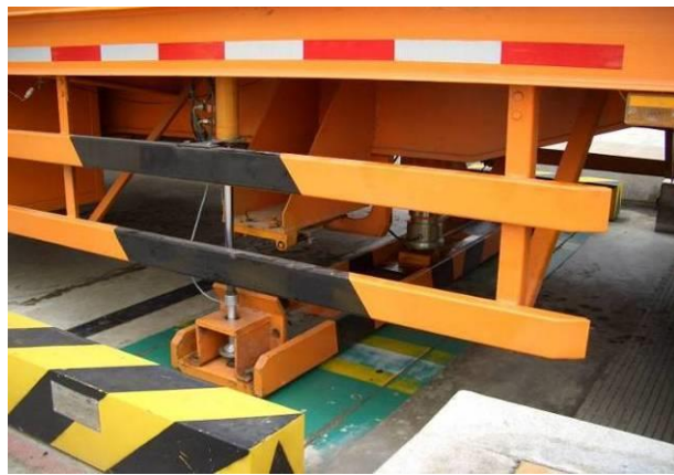
图1 专用检衡车进行静态检定
