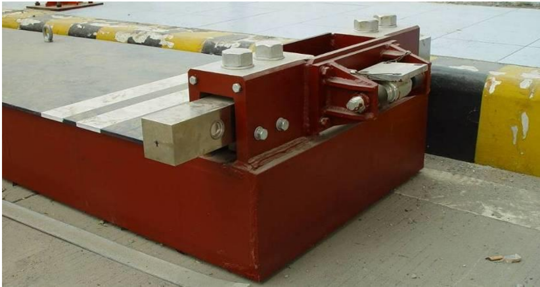
图3 秤台式轴重秤（上翻梁）外形结构图
