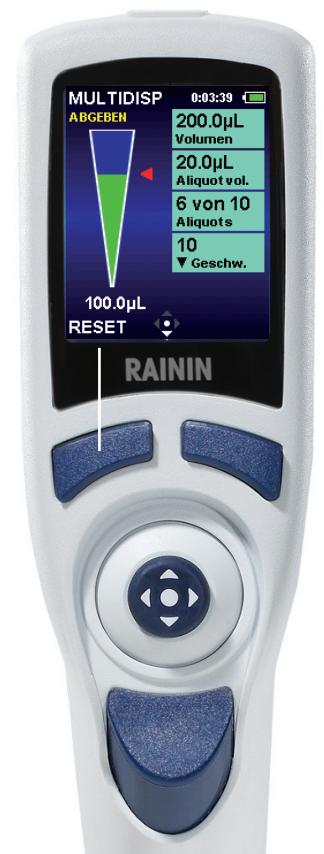
Abbildung 3: Bedienelemente der E4 XLS
