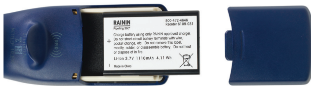
Abbildung 28: Austausch des Akkus
