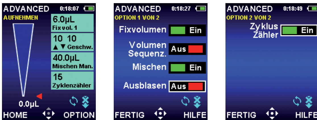
Abbildung 15: Optionen im Advanced-Modus: OPTION Softkey in der Betriebsanzeige (links), Option 1 von 2 (mittig) und Option 2 von 2 (rechts)
