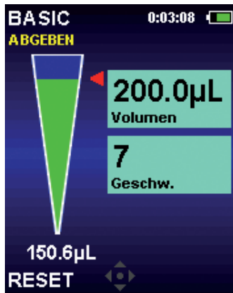
Abbildung 12: Abgabevorgang im Basic-Modus
