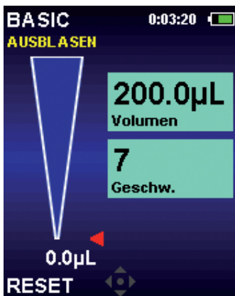
Abbildung 13: Ausblasvorgang im Basic-Modus
