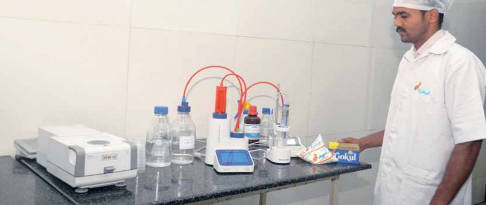
用于印度奶制品公司 Gokul 产品钠含量测定的梅特勒-托利多 EasyPlus™ 分析仪
