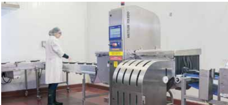
通过 X33 X 射线系统检查加工过的即食食品
