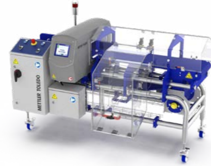
整体式传送带系统 新颖的传送带设计, 完全集成式金属检测解决方案
