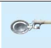
**标准型：配置SDTA单盘铂金传感器**，铂金盘下有一对热电偶测量样品温度。可通过样品温度和炉体温度差计算给出热流信号。
